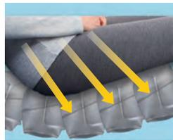
従来のエアセルは、背上げ中の斜め下へ向かう力によってエアセルが押されて足元方向に変形する分、腰部も一緒に移動する傾向にあります。予め18度の傾斜をつけた傾斜型2層式エアセルなら、斜め下へ向かう力を受け止め、足元方向へのエアセルの変形を抑えて身体のずり落ちを軽減します。
