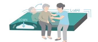
ご利用者様の起きあがりやマットレス端部への寝返り、端座位を検知し、マットレス全体の内圧を自動で上げてかたします。膨らんでいた4つのスモールフローセルは自動で縮みます。
