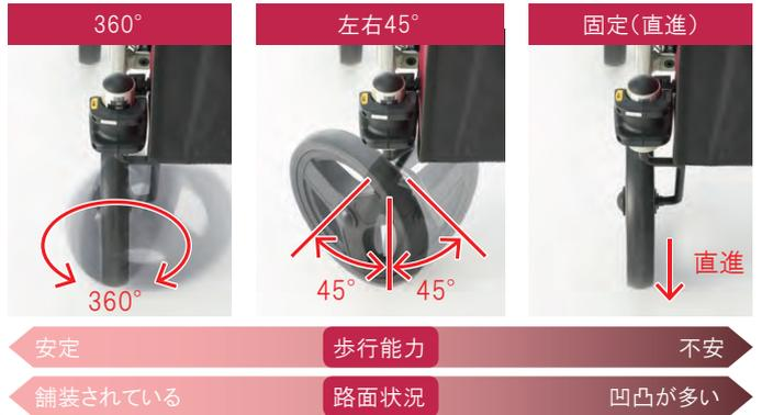
前輪回転制御レバーを上下にスライドすることで首振りの切替ができます。
